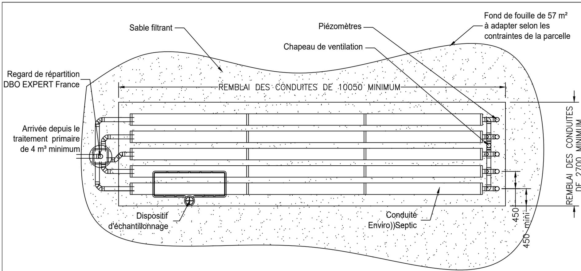
Pour ES7EH-B ND, la surface du fond de fouille doit être de 57 m<sup>2</sup>.
