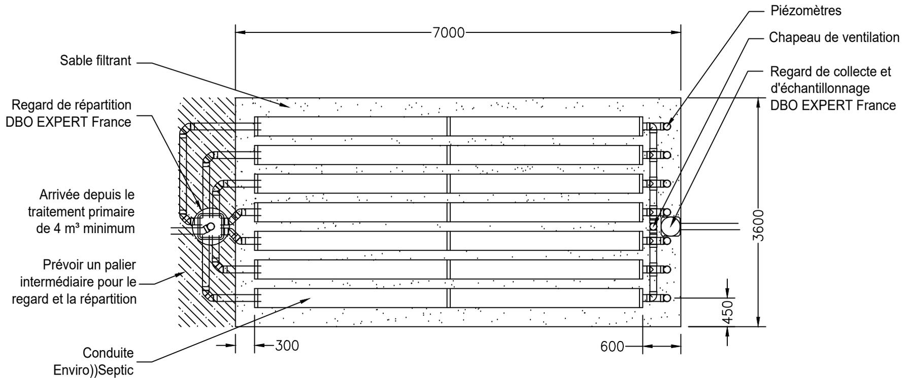
**VENTILATION :** La ventilation primaire et secondaire (équipée d'un extracteur statique) doivent être installées conformément à la norme NF DTU 64.1.
